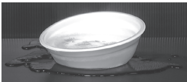
発泡ポリスチレン製容器が破損し、湯が漏れ出したようす
